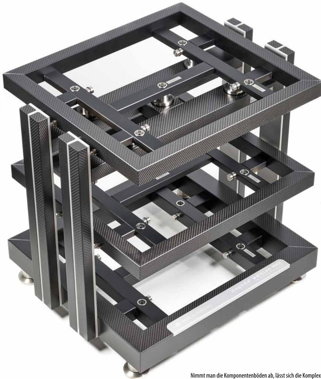
Nimmt man die Komponentenböden ab, lässt sich die Komplexität der Konstruktion zumindest erahnen. Gut zu erkennen sind im Bild die in die Tragrahmen eingelassenen Metallaufnahmen für die Keramik-Kugelbolzen, die die Böden aufnehmen. Bei den waagrecht eingelassenen Metallzylindern handelt es sich um die Endstücke der Resonatoren, die für jede Ebene separat abgestimmt sind.
